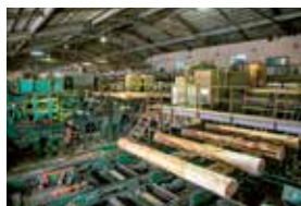
皮を剥いだ丸太が工場内を流れていきます
